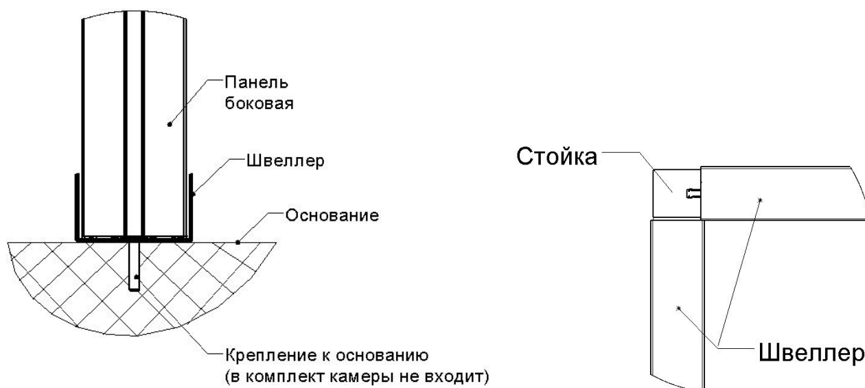
Рис.1а Установка панелей на швеллер
